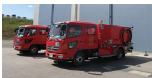
可搬型代替低圧注水ポンプ
