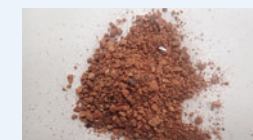
ふるい分けされた瓦のうち、細粒部分をコンクリート用の砂の一部として利用する方法を検討。
