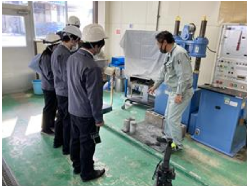
写4-7 打設後（圧縮強度試験立会）
